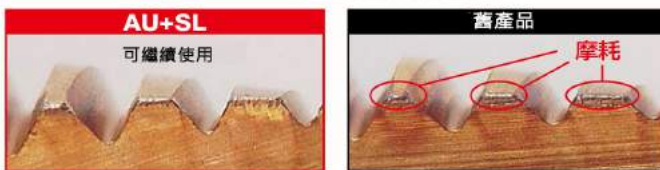
加工3000孔後刀尖的狀態
