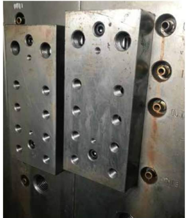
冷却孔采用了很多Rc ( PT ) 的螺纹
